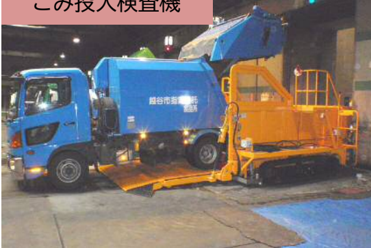
ごみ投入検査機
