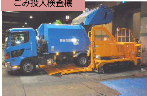
ごみ投入検査機
