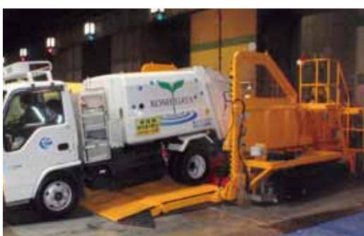
ごみ投入検査機 (黄色の機械)
