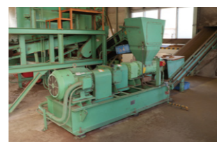
2-3 三次破碎 枝のみ、微生物の力を十分に活かすために特殊なすりつぶし処理をします。
