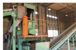
2-2 二次破碎 二次破碎機でさらに細かく破碎します。
