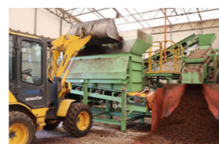
3-3 ふるい ふるい機により選別をしながら、異物も除去します。
